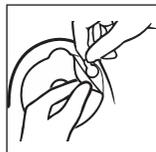
Pokud je třeba zabránit úniku plynu, umístěte jeden z příložených štítků filtru na filtr.
